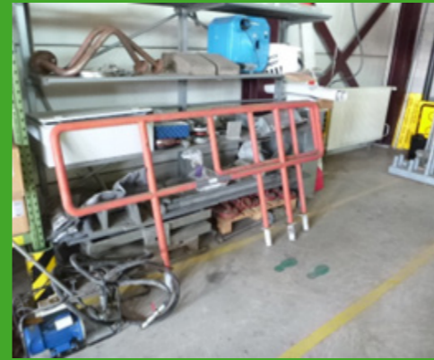
Foto 29: coating op losstaand hekwerk (chrom-6)
